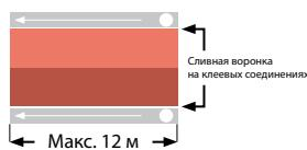
Если водосточные желоба образуют «прямую линию без уклона», как показано на рис. А, и их длина не превышает 12 м, можно использовать сливную воронку на kleевых соединениях. Компенсация будет происходить на свободном конце водосточных желобов вдали от сливной трубы.
