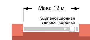
Если конфигурация соответствует рис. В и есть препятствия линейному расширению желоба, то используется компенсирующая воронка при условии, что длина карниза не превышает 12 м.
