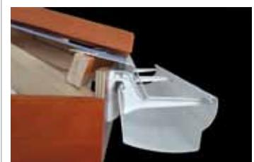
Гидроизоляционная пленка укладывается поверх капельника. Пленка крепится к капельнику скобами или гвоздями.
