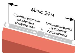
Если длина водосточных желобов превышает 12 м и они образуют «прямую линию с уклоном или без него», как показано на рис. С, понадобятся две сливные воронки на kleевых соединениях и один компенсатор\*. Расстояние между двумя сливными воронками не должно превышать 24 м.
